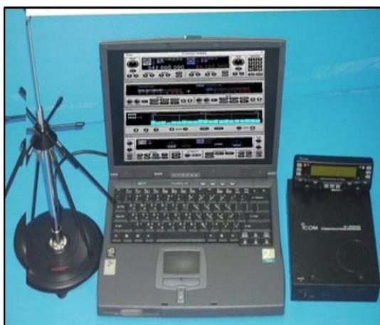
圖 3 IC-PCR2500 全頻段接收機電腦介面
