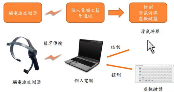
圖八、控制滑鼠游標與虛擬鍵盤系統架構圖
