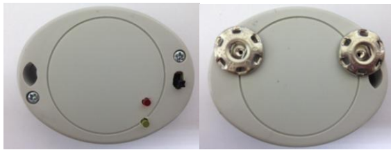
圖 12 發射裝置實體正/背面圖
