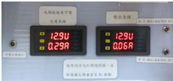
圖 5 太陽能充電電流 0.29 安培(A)
