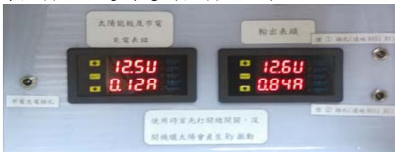
圖 7 兩顆 LED 開啟時輸出電流 0.84 安培
