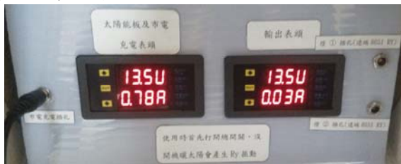
圖 6 市電充電電流 0.78 安培(A)
