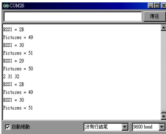
圖 4. 導覽器所收到定位器訊號之訊號強度值
