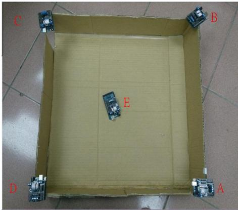
圖 3. 定位系統實作圖，定位節點各別是 ABCD，E 參觀者節點(導覽器)。
