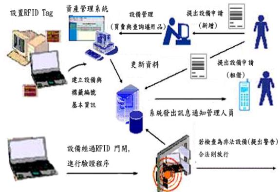
圖 3 系統整體運作架構圖
