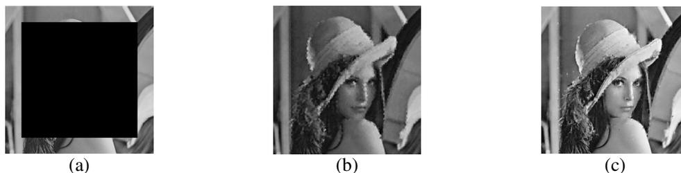
圖 7 (a) 將 Lena 裁切 60% (b) 為 Lee et al.的復原影像，PSNR 為 25.20 dB (c) 為本論文復原影像，PSNR 為 27.8597dB
