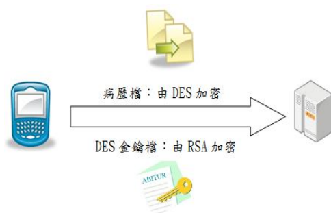
圖 7 PDA 傳輸加密之架構
