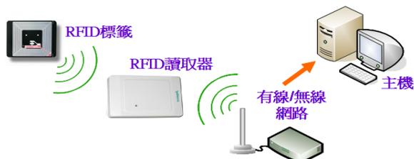
圖1 RFID系統構成圖
