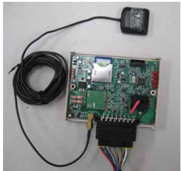
圖 4. 行車記錄器硬體示意圖
