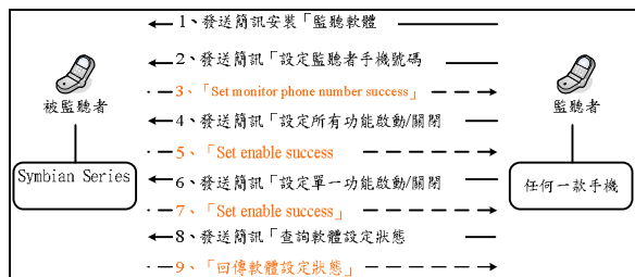
圖 9 手機竊聽軟體設定流程圖 (Symbian S60)
