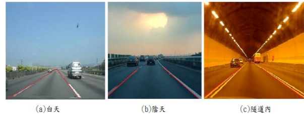
圖 14 (a)白天(b)陰天(c)隧道內車道線偵測結果
