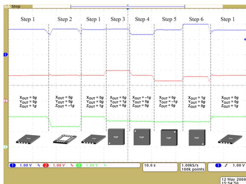
圖-21：加速規活動實際量測圖
