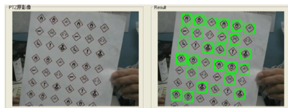
圖 16 GHS 危害圖示旋轉 20 度偵測結果
