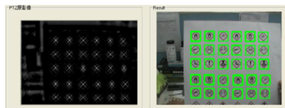
圖 15 GHS 危害圖示之影像偵測結果
