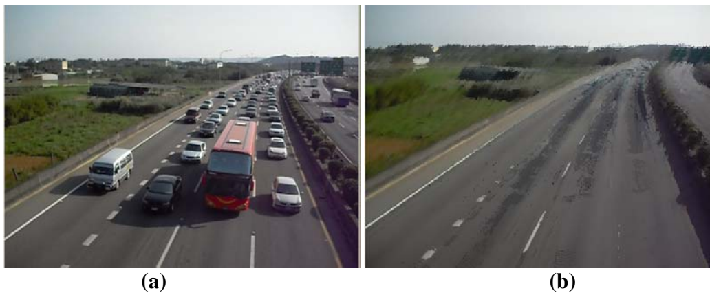
圖 3. (a)原始影像(b)高斯混合模型所建立之背景。
