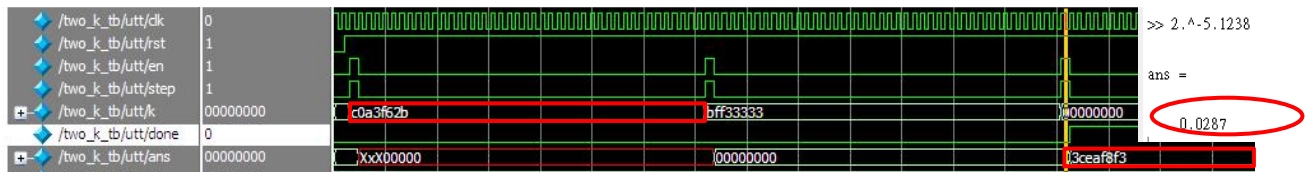
圖 9. 2^k 部分採並列架構之模擬結果(ModelSim 及 Matlab)
