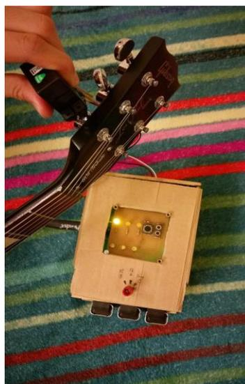
圖 8. 馬達連接電吉他示意圖
