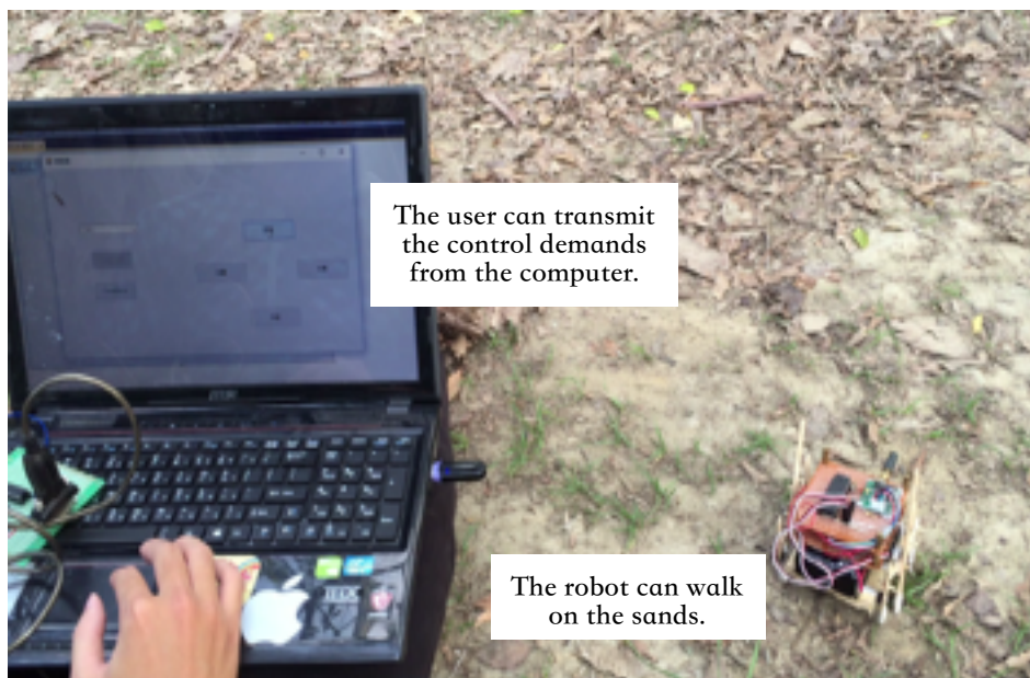
圖6 六足仿甲蟲步態機器人根據使用者之控制命令在沙石地上行走圖
