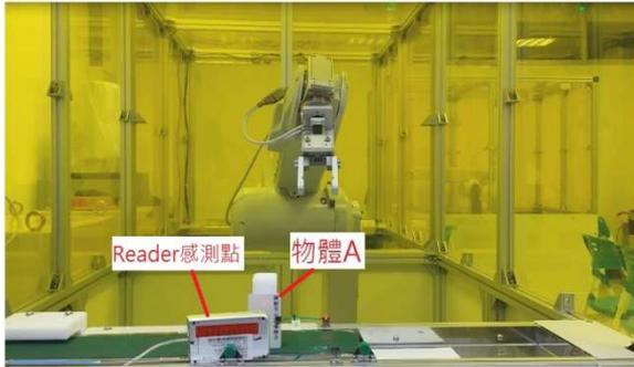
圖 18、物體經過 RFID 感測點進行讀取判斷
