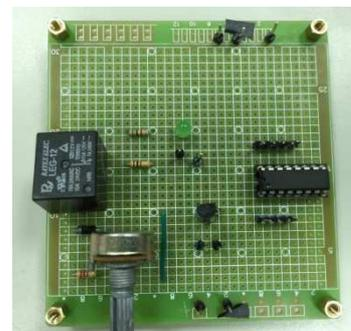
圖 5 光敏電阻與馬達驅動電路板
