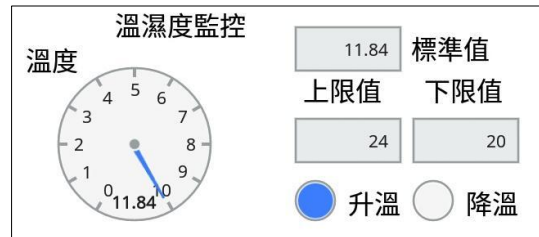
圖七(c).平板，溫度過低
