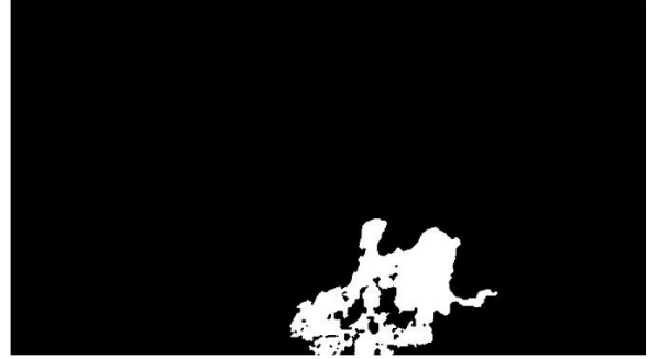
圖四、執行遮罩與斷開閉合後的火焰候選區域
