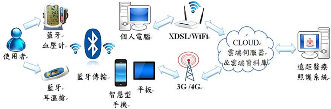
圖 1. 藍牙遠距醫療照護系統架構
