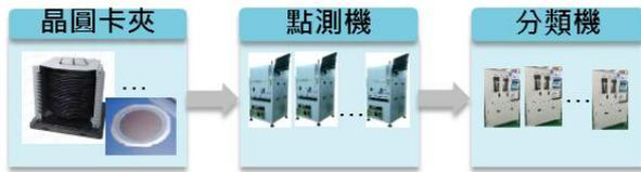
圖一、LED 晶粒簡易製造過程
