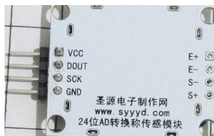
圖 3 電子秤感測模組
